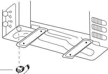
以排水彎管安裝在室外機的底部，
