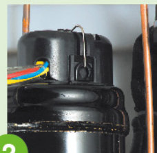
2 兩段式過負荷保護器 (電流、高溫保護) (F-Y103SW/MW為過負荷保護器)
