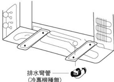
以排水彎管安裝在室外機的底部，以便排出冷凝水。
