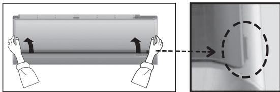
面板開啟與關閉，請務必抓取左右兩側凸緣處避免施力不當造成卡榫斷裂
