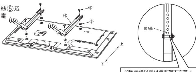
如圖示請以電視機支架下方第1孔做基準，先鎖緊後再鎖上方的螺絲。
