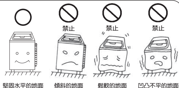
堅固水平的地面 傾斜的地面 鬆軟的地面 凹凸不平的地面
