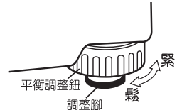
圖(三) 上側圖示調整腳操作步驟
