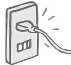
由電源端拉出插頭或用夾子拉電線端，都易造成火災，觸電等現象發生。
