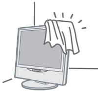
散熱孔被阻塞時，內部熱氣無法散出易產生火災或故障等現象，以下幾點請注意：
